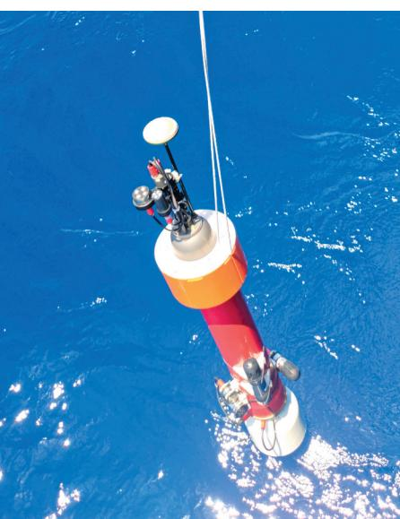
这是我国自研海洋生物地球化学原位传感器搭载Argo浮标海试布放现场(2025年5月15日摄)。
