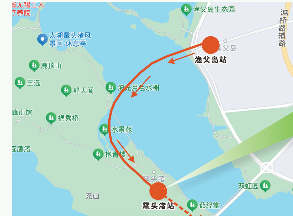
这条横跨蠡湖核心水域的隧道近八成线路处于湖面之下,施工难度非同一般。“湖底岩层坚硬、水压大、覆土薄,加上地处蠡湖风景区,生态环保标准严苛、多重施工风险叠加,让这段穿湖工程成为全线头号‘硬骨头’。”
