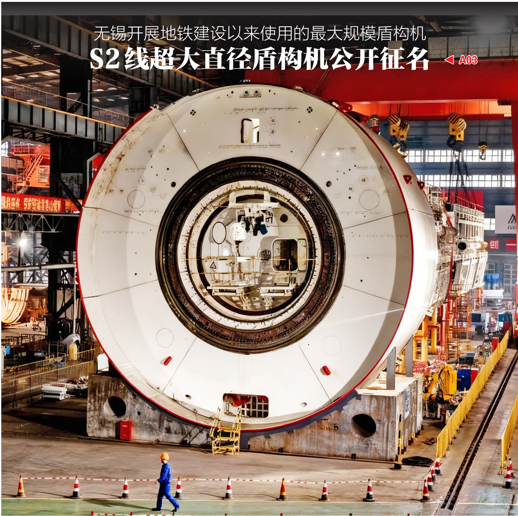
正在组装中的超大直径盾构机。(受访者供图 AI校色)
