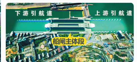
新建两线单级船闸，扩挖上下游引航道 船闸主体段全长400米
