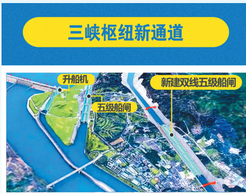
三峡枢纽新通道在已建三峡船闸北侧
